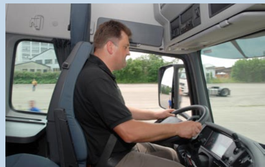
Fahrerlehrer mit langen Beinen konnten ihren Sitz im Fahrschul-Lkw nicht weit genug nach hinten schieben und rutschten bei der Gefahrenbremsung die Lehne entlang nach oben
