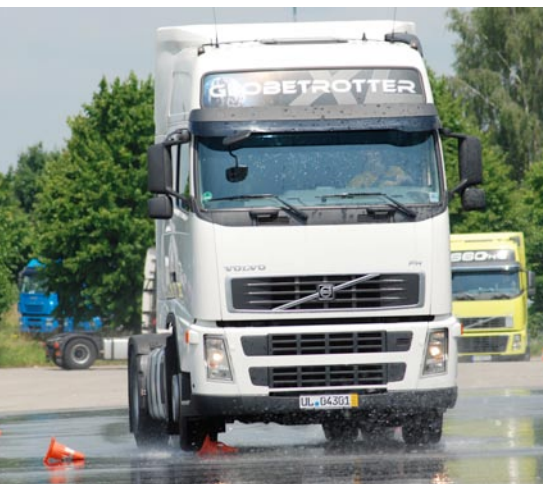
Ohne ESP war das Ausweichen auf nasser Fahrbahn schwerer als mit dem gelben FH 660, der ESP hatte
