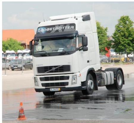
Bei der Gefahrbremung auf einseitig glatter Fahrbahn kam es auf gefühlvolles Gegenlenken an, weil die entlastete Hinterachse sonst leicht ausbricht
